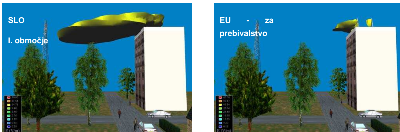
Slika 2. Vplivno območje (električna poljska jakost v V/m) v okolici bazne postaje glede na Uredbo o elektromagnetnem sevanju (UL RS 70/96) ter priporočila EU za prebivalstvo. Iz obeh slik je natančno razvidno, da se za isto konfiguracijo bazne postaje v Sloveniji zaradi 10-krat nižje mejne vrednosti na I.območju varstva pred EMS zahteva večje vplivno območje kot pa v drugih državah članicah EU, kjer se upoštevajo priporočila EU.
